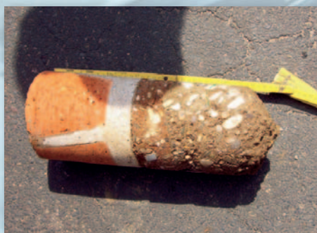
Bohrkern nach der Sanierung
