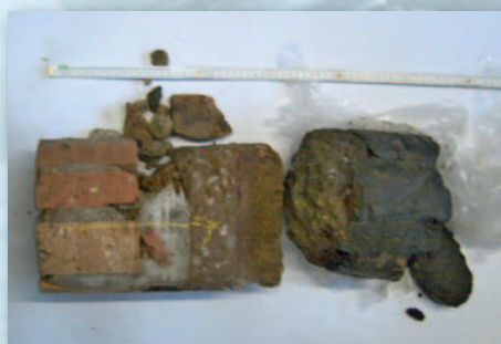
Bohrkern der Bestandsaufnahme
